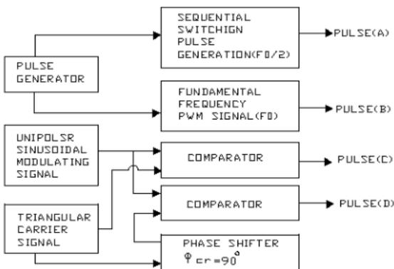
Fig: 8. Base modulation generator – HPSCPWM
