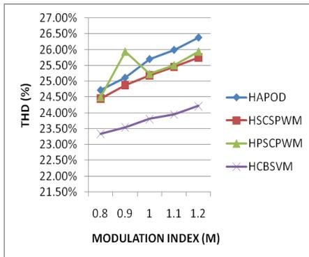
Fig: 20. Modulation index versus % THD
