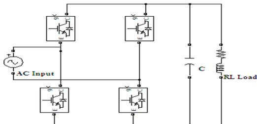
Fig: 1. PWM Single Phase Rectifier Simulation Circuit
