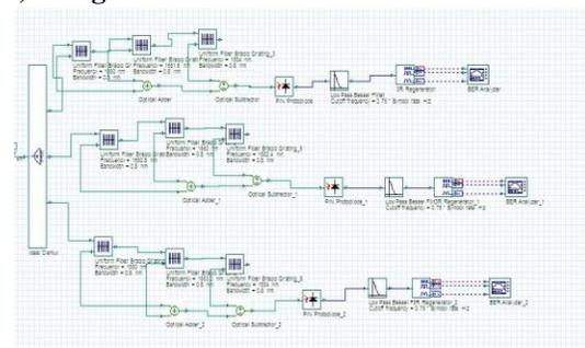
**Fig. 5. Single Photodiode Detection**
