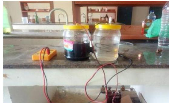
Fig.no.1 MFC set up
